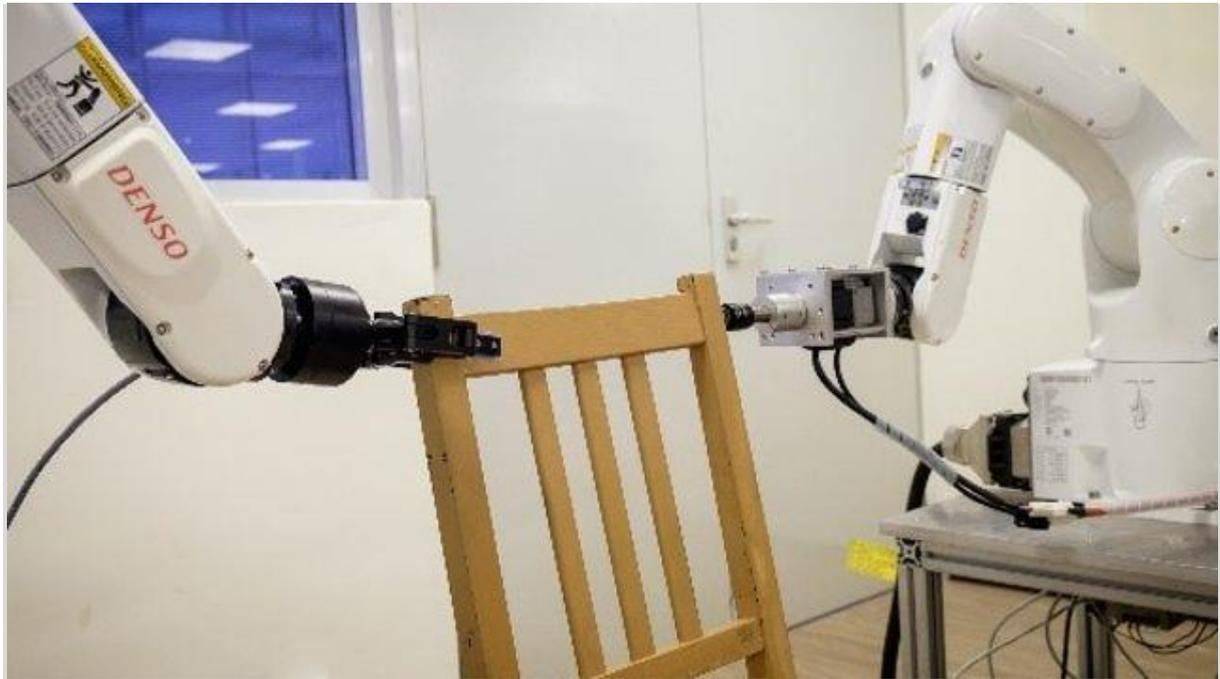
备有三维摄像机的机器人能辨识不同部件，两个机械手装有压力传感器，确保机器人施展的力道适中（照片：NTU）
